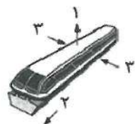
شکل ۲- سیستم‌های تشکیل‌دهنده مگلو در طراحی سیستم‌های مگلو فوق از نیروهای مغناطیسی به‌منظور اجزای سه هدف ذکر شده استفاده می‌شود.
